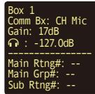
2. LWB ユニットの MAIN モジュールの SETUP スイッチを押し、ノブを操作して (回す/押す) Main Rtn# を 1 に設定する。
