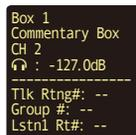
2. LWB の MAIN モジュールの SETUP スイッチを押し、ノブを操作して (回す/押す) Group # を 1 に設定する。
