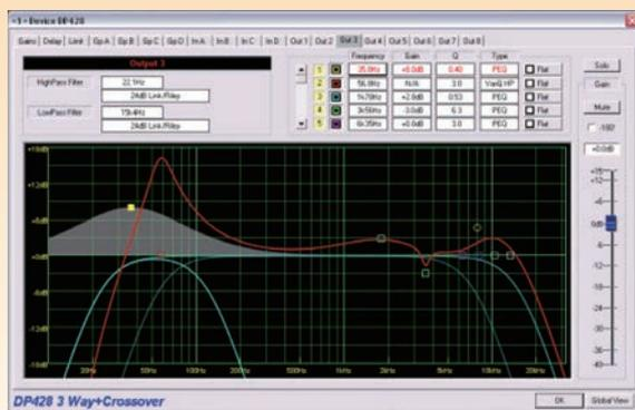
さらに、SiDD のバウンシング・ボール表示に加え、オート・ダイナミック EQ カーブ表示も登場した AudioCore がフルサポート。ダイナミック EQ の効果をリアルタイムに視覚的に確認できます。
