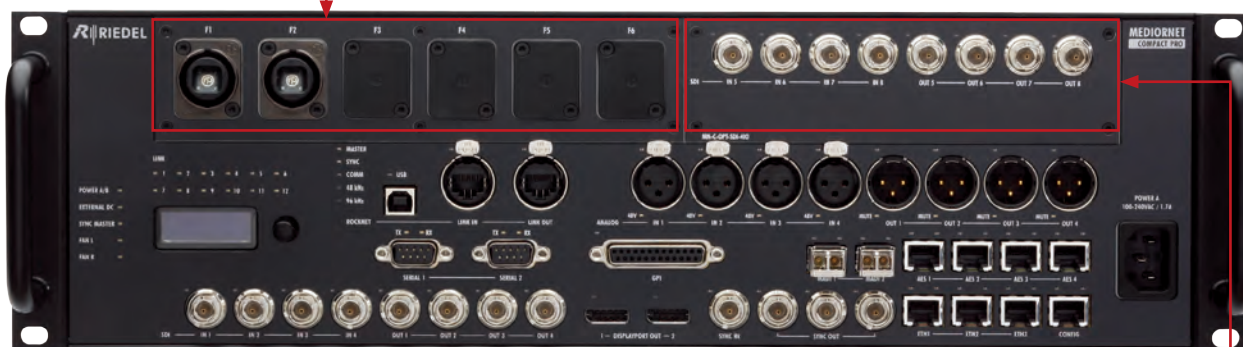
オプション・ボード用スロット (MediorNet Compact Pro のみ)
