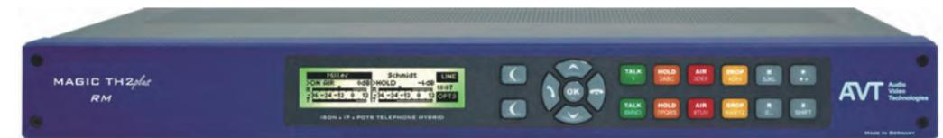
MAGIC TH2plus RM は、電源内蔵の MAGIC TH2plus の 19 インチバージョンで、2 系統の POTS インターフェイス、ISDN BRI を 1 系統と VoIP 用の LAN インターフェイスを 1 系統、そしてアナログおよびデジタルオーディオインターフェイス（設定可能）を提供します。さらに PC ソフトウェアを使うことなく簡単に操作できるように MAGIC TH2plus RM は色付きの前面キーパッドを備えています。
