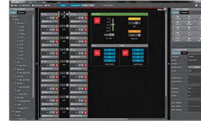
ArrayCalc の R1 エクスポート機能によって、スピーカータイプやアンプ設定などを含むすべてのシステムデータが、R1 リモートコントロールソフトウェアに転送され、これが制御と監視が行われるすべての対象についての詳細である、完全なシステムコンフィグレーション情報ベースとなります。R1 リモートコントロールソフトウェアはシステムをグラフィカルに表現します。
