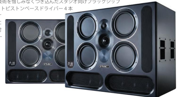
**QB1-A**：フィニッシュ色：スタジオブラック●周波数特性：20 Hz～25 kHz ●最大音圧レベル：132 dB (@1 m) ●ATL™実効長：2.7 m ●クロスオーバー周波数：380 Hz、3.8 kHz ●ドライブユニット：LF PMC カーボンファイバー /Nomex® 250 mm (10") ピストンドライバー ×4、MF PMC 75 mm ソフトドームドライバー、HF アコースティックラジエーター付き PMC 34 mm ソフトドームツイーター●入力インピーダンス：20k バランス●入力感度：+4～+20 dBu 可変●コネクター：バランス式アナログ、デジタル AES3 ●チャンネル毎のアンプ出力パワー：LF 4,000 Wrms、MF 550 Wrms、HF 275 Wrms ●寸法、重量：820H×1,092W×523D mm、150 kg
