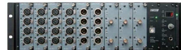
ADS-72 のモジュール構成例：フロント接続タイプのモジュールを使用
