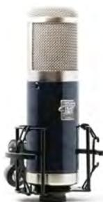
ニュートラルな周波数特性と高い入力感度と非常に低いセルフノイズを実現したプレミアムなスタジオコンデンサーマイク。クリアで透明感のある音質をもたらすトランスレス回路を使用。この回路は雑音レベルの低いNOS (New Old Stock) トランジスターとヨーロッパ産コンデンサーを使って国内で製造されています。オムニ/カーディオイド/8の字のパターン切り替えと-10dBパッドのオン/オフ可能。付属のショックマウントはフラッシュマウントが可能で、歌手や奏者はマウント金具に邪魔されることなく、簡単にマイクと近いポジションがとれ、マイクの自然な近接効果を得ることができます。
