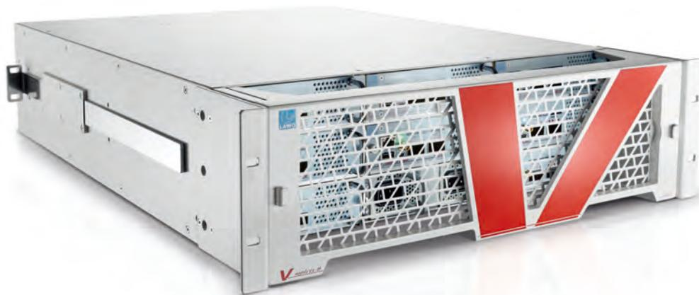
V\_\_matrix は ST-2110, ST2022-7 に対応した IP ルーティング/プロセッシングのプラットフォームとして内部スロットに複数台の C100 IP ビデオ・プロセッサを搭載します。40GbE で接続された IP ストリームは 4K/HDR に対応した Multiview Module, Format Converter Module などのアプリケーションを追加して様々な拡張機能を持たせることが可能です。またシステム・コントローラーとして VSM を使うことにより、周辺機器を含めたトータル IP コントロールを実現します。
