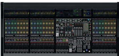
16 + 24 C + 16 (幅: 2353 mm/ 奥行き: 1078 mm/ 重量: 152 kg)
