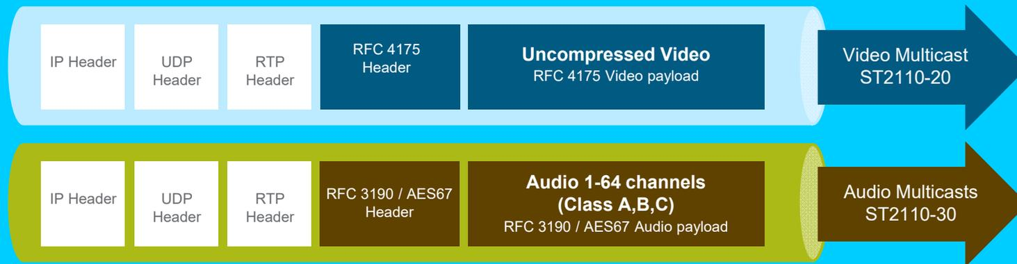
音声部分に関してはAES67規格を参照していますが、オリジナルのAES67プロフィールにいくつかの制約が追加され、A, B, Cの各クラスとして定義されています。そのため音声エッセンスはST2110-30規格内で定義されています。
