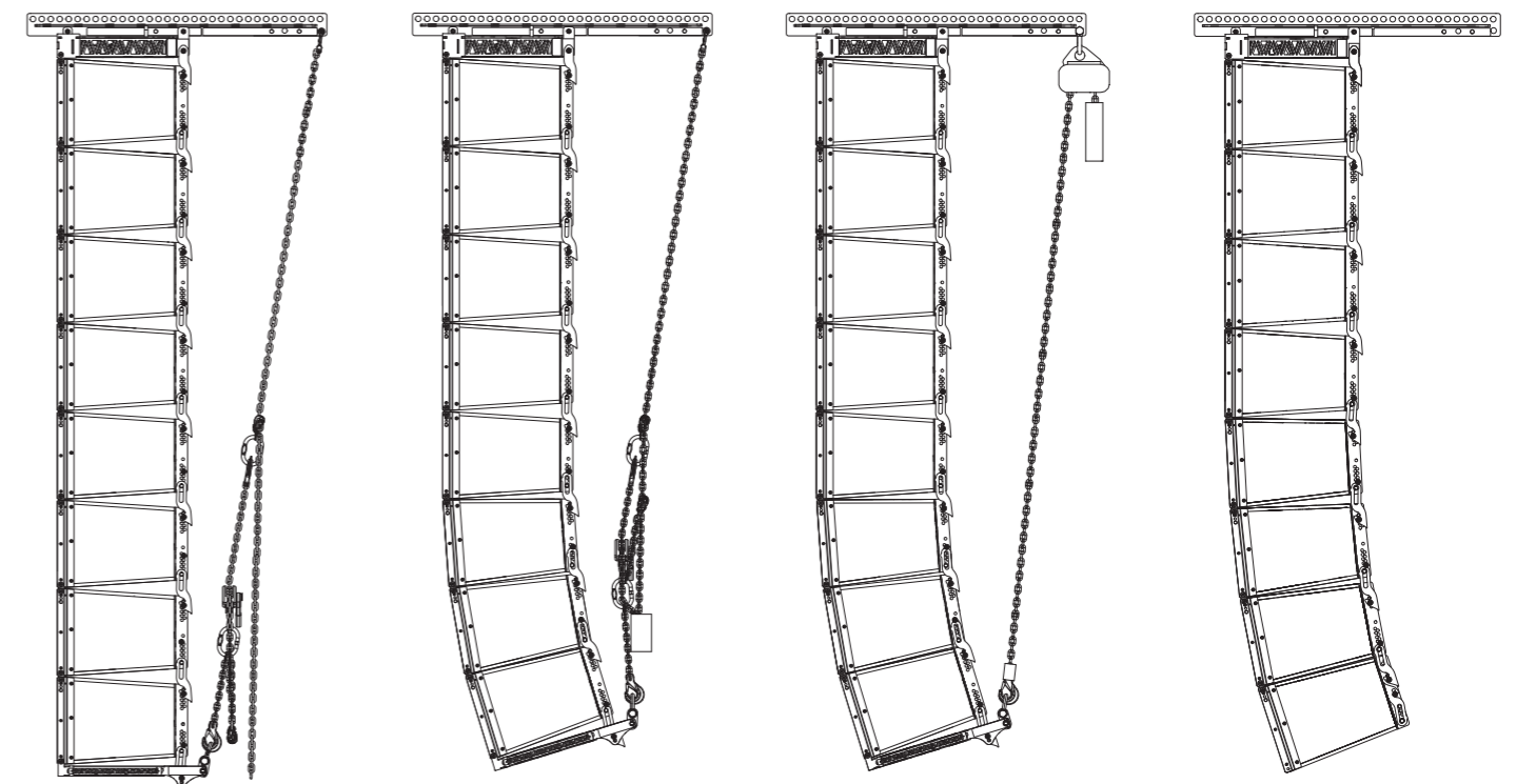
レバーホイストを使用したコンプレッションモードアレイ (レバーホイスト使用前)
