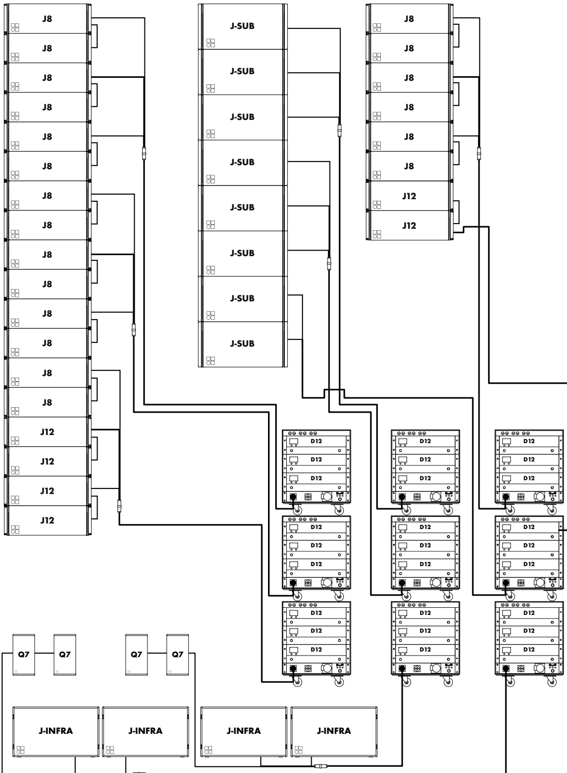
J8/J12 メインとJ-INFRAのアウトフィルをサブアレイとしてJ-SUBのフライングコラムに沿ってグラウンドスタックし、Q7をニアフィルとした時のJ-Series エリア構成例
